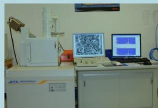
Fig. 7: Microscope électronique à balayage
