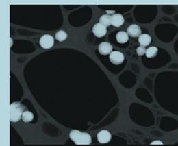
Fig. 8: DOLLOPS - nanoparticules de CaCO<sub>3</sub>
